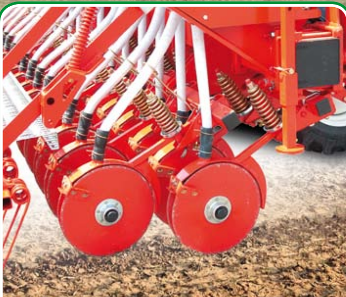
Сошник с двойным диском с регулируемой пружиной сжатия Brăzdar cu disc dublu cu sistem amortizor reglabil Redlica z podwójną tarczą z regulowaną sprężyną dociskową
