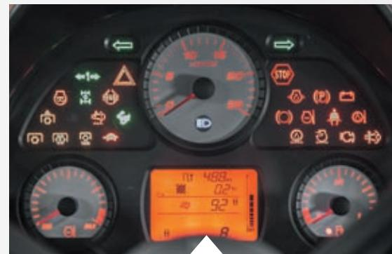
На приборной панели в расширенной версии отображаются значения частоты вращения коленчатого вала и ВОМ, интервалы технического обслуживания, расход топлива, пройденное расстояние, обработанная площадь, температура масла, наработка трактора, занесенная в память частота вращения коленчатого вала, данные о техническом обслуживании.
