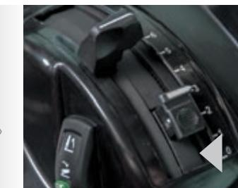
Органы управления системой ELC в расширенной версии.
