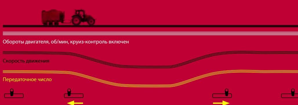
Автоматический режим оптимален для большинства операций в поле и на дорогах. В автоматическом режиме используется максимально возможное передаточное число для оптимального использования топлива.
