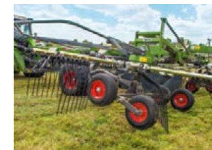
При опускании на разворотных полосах сперва земли касаются задние колеса, а потом – передние. При подъеме роторы сперва поднимаются в передней части. Jet-Effect защищает стерню поля.
