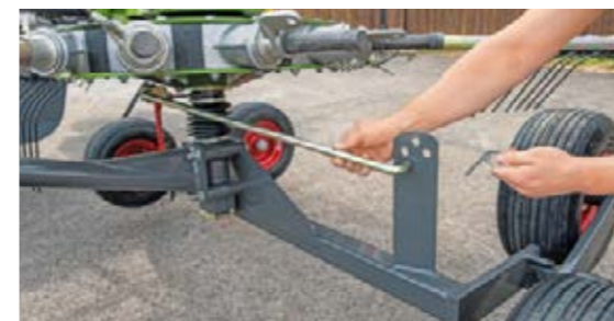
Каким бы ни был корм – длинным и тяжелым или коротким и легким: Кулачковую направляющую можно легко отрегулировать в зависимости от условий работы.
