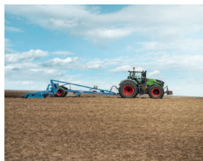
→ Благодаря системе управления трактором TMS и автоматической системе регулирования предельной нагрузки 2.0, трактор подбирает оптимальные обороты двигателя к текущей скорости движения.
