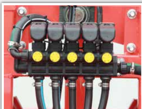
Электроклапаны: для управления секциями штанги
