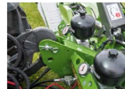
Благодаря полевому манометру вы сможете всегда держать в поле зрения показатели прижимного давления системы TurboLift и регулировать его непосредственно из кабины.
