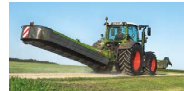
В транспортном положении косилка может подниматься из кабины под углом 90°.
