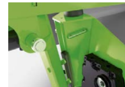
Патентованная направляющая отвечает за оптимальное ведение и стабильность косилочного бруса.
